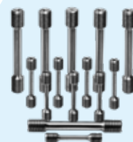
金属材料棒材拉伸样品
