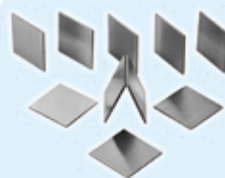
金属材料盐雾腐蚀样品
