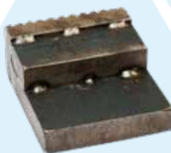
钢结构焊缝 UT 检测样品
