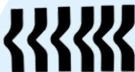
橡胶撕裂样品
